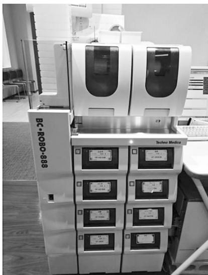
BC・ROBO-888(全自動採血管準備装置)
