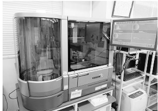
全自動輸血検査装置 ORTHO VISION
