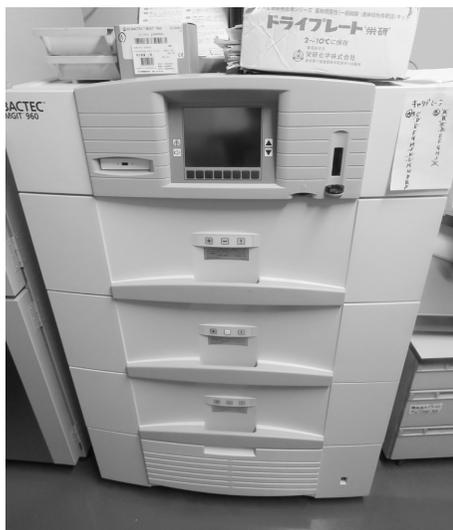
全自動抗酸菌培養検査装置
