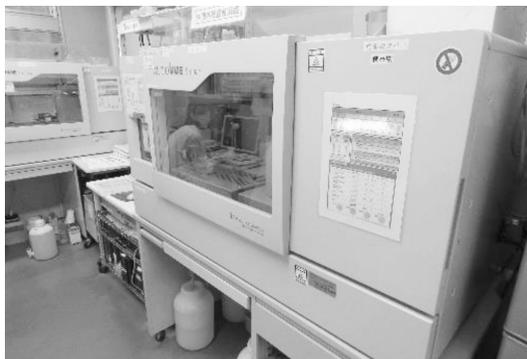
全自動輸血検査測定装置
